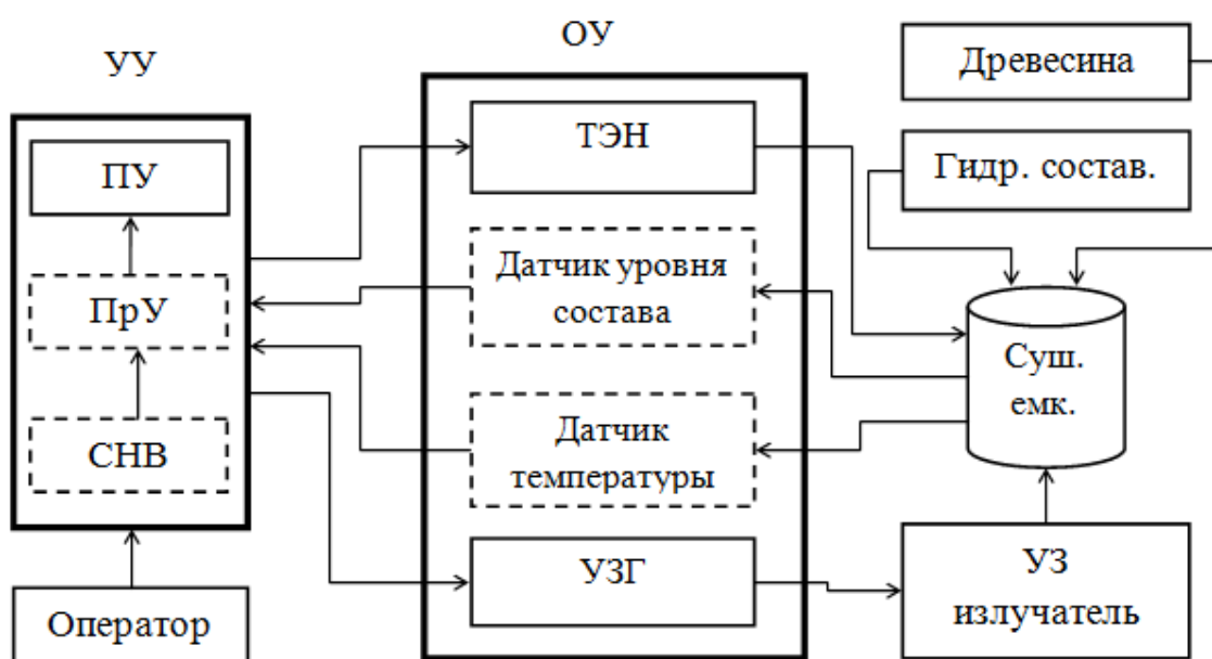
Рис. 1. Структурная схема сушильной установки
