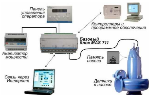
Рис. 3. Комплексная система мониторинга, контроля и записи на базе MAS 711 для повышения безопасности, доступности и снижения эксплуатационных расходов
