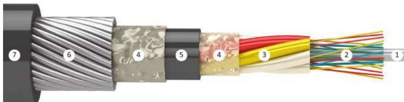
Рис. 1. Оптический кабель марки ДПС: 1 – центральный силовой элемент (ЦСЭ): стеклопластиковый диэлектрический стержень, стальная проволока, 2 – оптическое волокно, 3 – оптический модуль со свободно уложенными волокнами в оболочке из ПБТ и заполненный гидрофобным наполнителем, 4 – межмодульный гидрофобный наполнитель, 5 – промежуточная оболочка из полимерного материала, 6 – броня из стальных оцинкованных проволок, 7 – защитный шланг из полимерного материала
