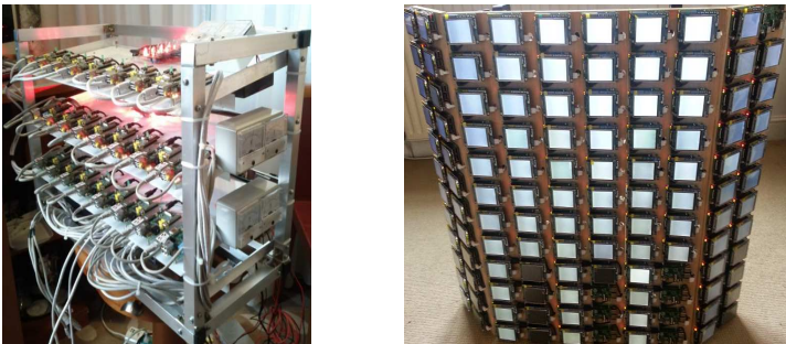
Рис. 4. Вычислительные центры на основе 20 и 120 микрокомпьютерах Raspberry Pi
