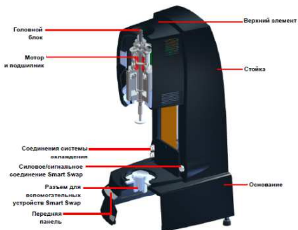
Рис. 1. Схема реометра DHR-2 TA Instruments
