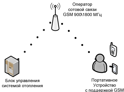
Рис. 2. Дистанционное управление системой отопления
