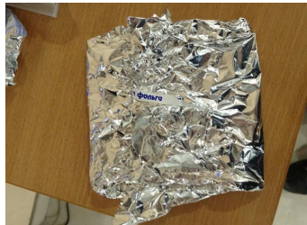
Рис. 2. Экспериментальный носитель с RFID-меткой в фольге
